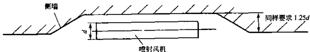
图 6-9 射流风机在侧墙上嵌入安装
