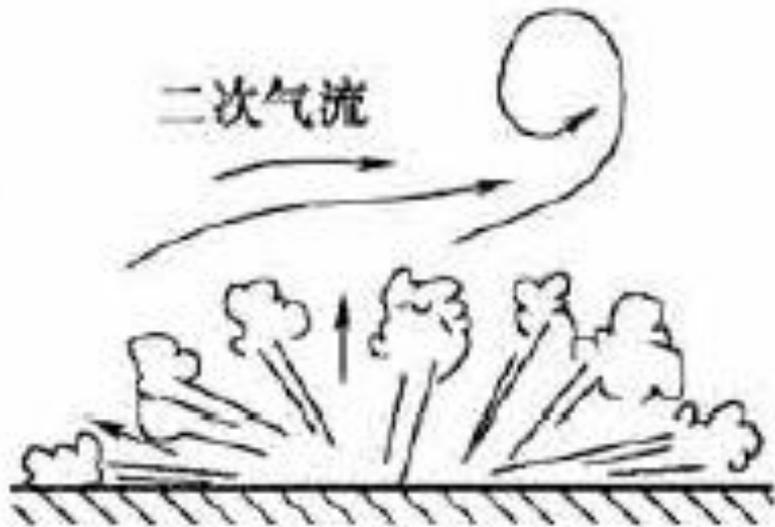
图 1-5 二次气流对粉尘扩散的作用
