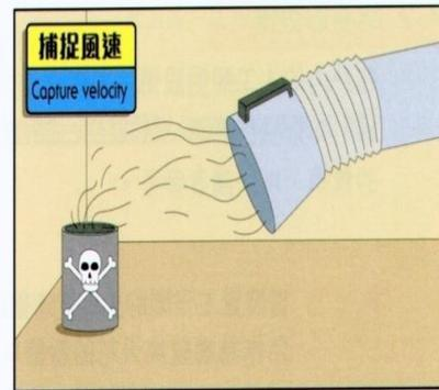
捕捉風速—是指於污染物來源處的所需風速，其氣流速度足以將污染物成功地帶進抽風罩內。
